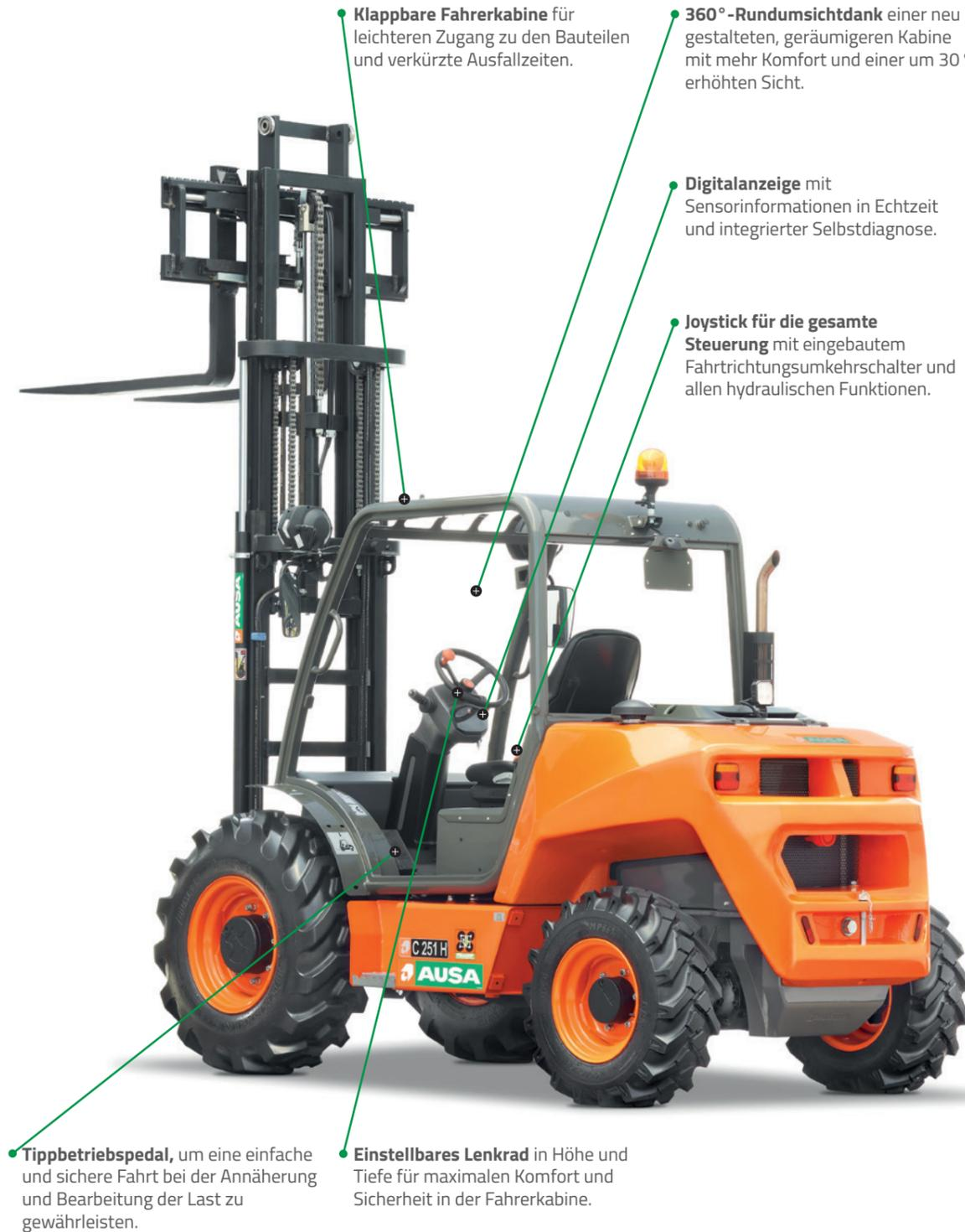
• **Klappbare Fahrerkabine** für leichteren Zugang zu den Bauteilen und verkürzte Ausfallzeiten.
