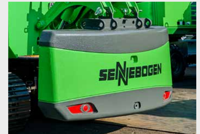
Optional ablegbares Kontergewicht mit Fernsteuerung für 825+ 830 Demolition
