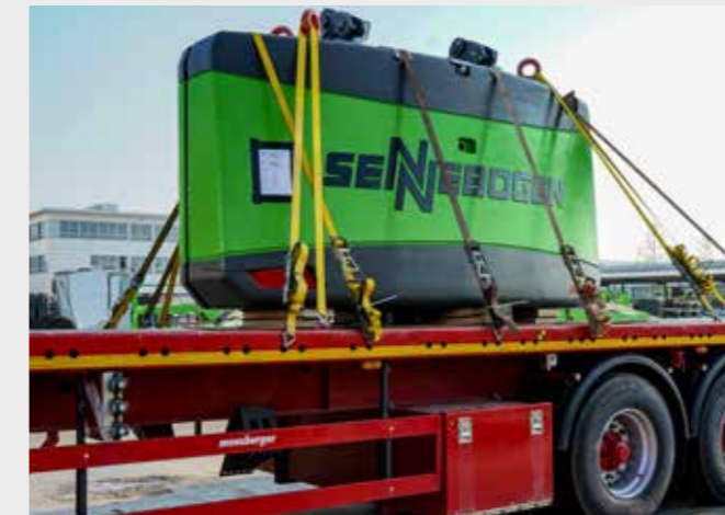
870 Demolition: Ablegbares Kontergewicht verringert Transportgewicht
