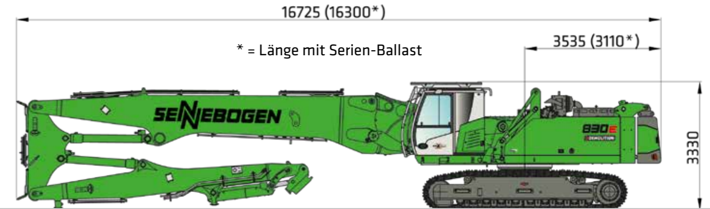
830 DEMOLITION MIT UNTERWAGEN T41/380 UND 3-TEILIGER ABRUCH-AUSRÜSTUNG AB23 (OPTION), HYDRAULISCH HOCHFABRBARE KABINE MAXCAB, 30° NEIGBAR UND VOLLHYDRAULISCH ABLEGBAREM KONTERGEWICHT (OPTION), EINSATZGEWICHT CA. 48 T
