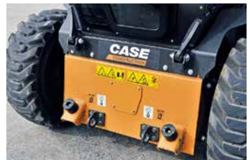
Direkte Abstützpunkte am Fahrwerksrahmen unterstützen die Schubleistung
